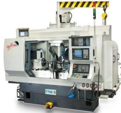
CNC Grinding Machine (OD & ID) – 4Nos
